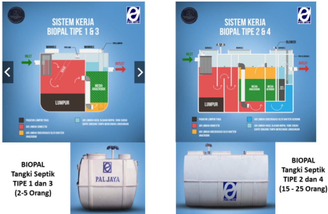
Gambar 5. Tipe Tangki Septik Sistem Sanitasi Setempat Biopal [14]
